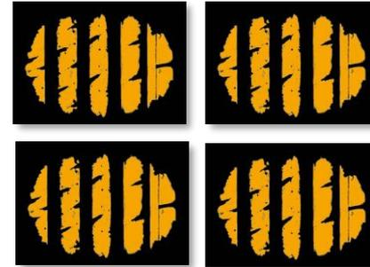
Las prestaciones de frenado del neumático se consiguen mediante 4 parches de contacto del tamaño de una postal. El neumático es el único punto de contacto con la carretera.
